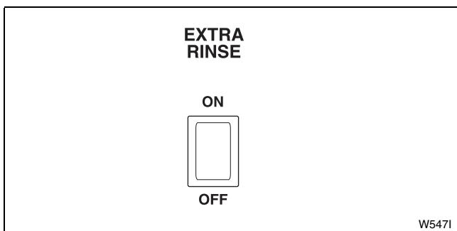
El control de segundo aclarado (EXTRA RINSE) resulta útil si se tiene piel sensible a los detergentes. Poniendo el correspondiente interruptor en la posición ON (activado), los tres ciclos de prendas corrientes, PERMANENT PRESS (prendas inarrugables) y DELICATE (prendas delicadas) brindarán un segundo aclarado. Cuando desee dicho segundo aclarado, coloque este interruptor en la posición ON (activado) y cuando no lo desee, colóquelo en la posición OFF (desactivado).
